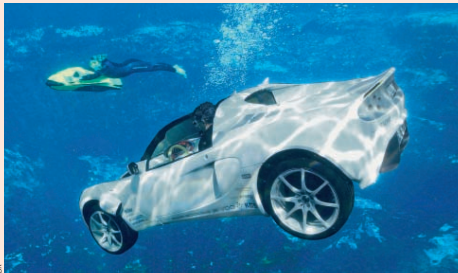
Under water, the roadster's passenger compartment is permanently open. Под водой салон родстера не закрывается
